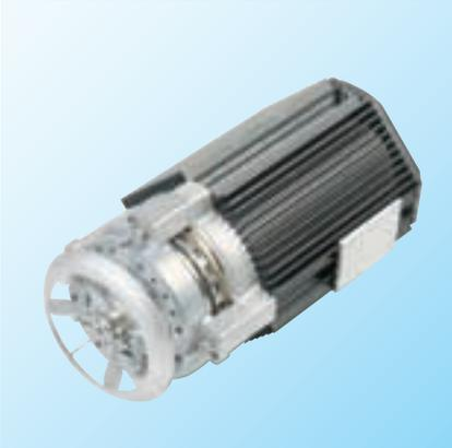
Moteur frein 2 vitesses, frein électromagnétique à rattrapage automatique d'usure. Protection IP 55. Classe F.
