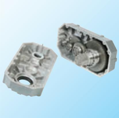
Réducteur à 3 trains, denture hélicoïdale rectifiée, lubrifiée à vie (graisse semi fluide) étanchéité assurée par joints toriques et joint à lèvres en bout d'arbre (BH2).
